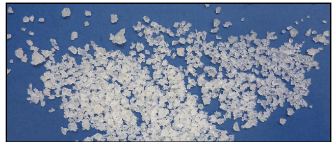
Granulometría: 70% comprendido entre 0 - 12 mm.
